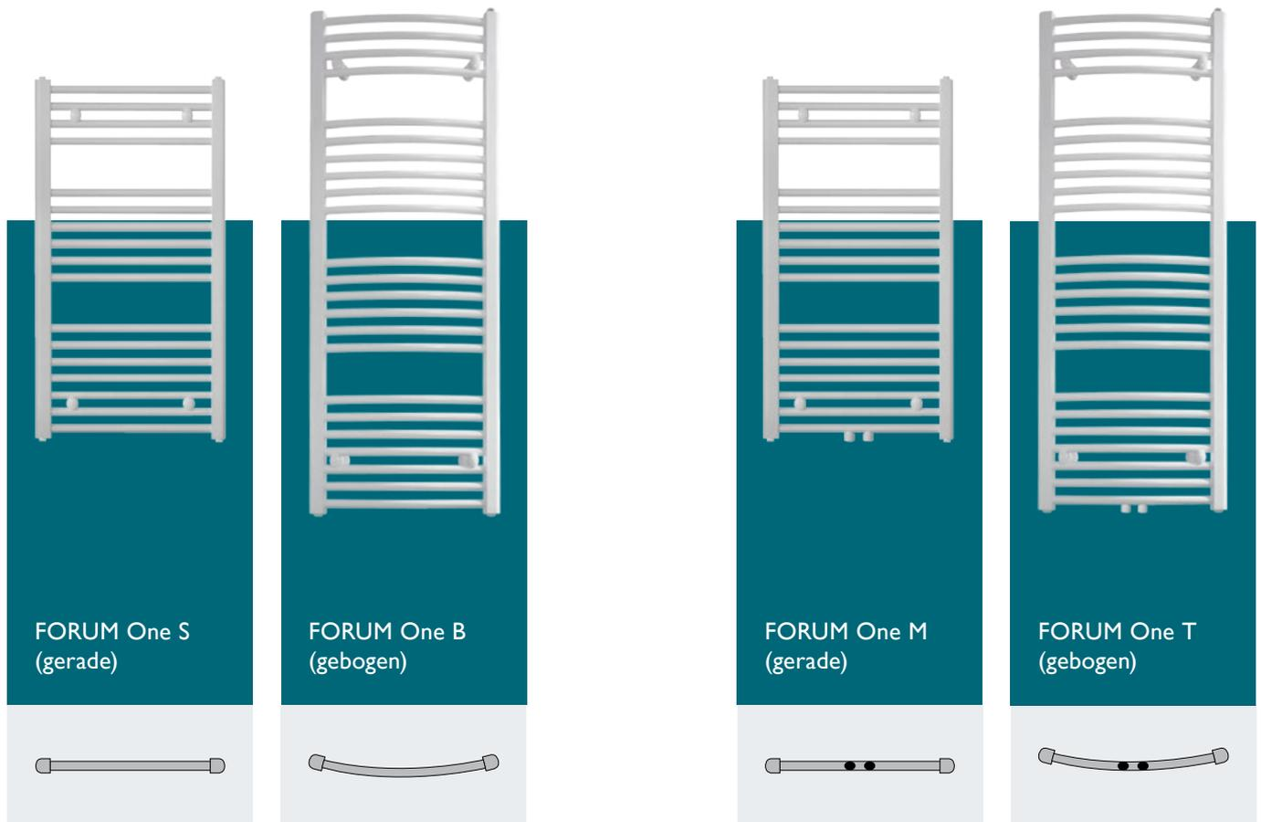
FORUM One Badheizkörper gerade oder gebogene Ausführung mit zwei Anschlüssen G 1/2" IG **unten in den senkrechten Sammelrohren** für Vorlauf- und Rücklaufanschluss an die Warmwasserheizungsanlage und oben zur Entlüftung inklusive Entlüftungs- und Blindstopfen.
