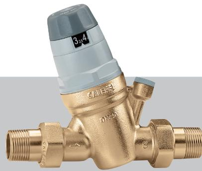
Druckminderer sind Geräte zum Einbau in Hauswassersysteme, um den eingangsseitigen Druck, der aus dem öffentlichen Wassernetz einströmt, zu reduzieren und zu stabilisieren. In der Regel ist dieser Druck zu hoch und zu schwankend, um direkt im Hauswassersystem benutzt zu werden.
